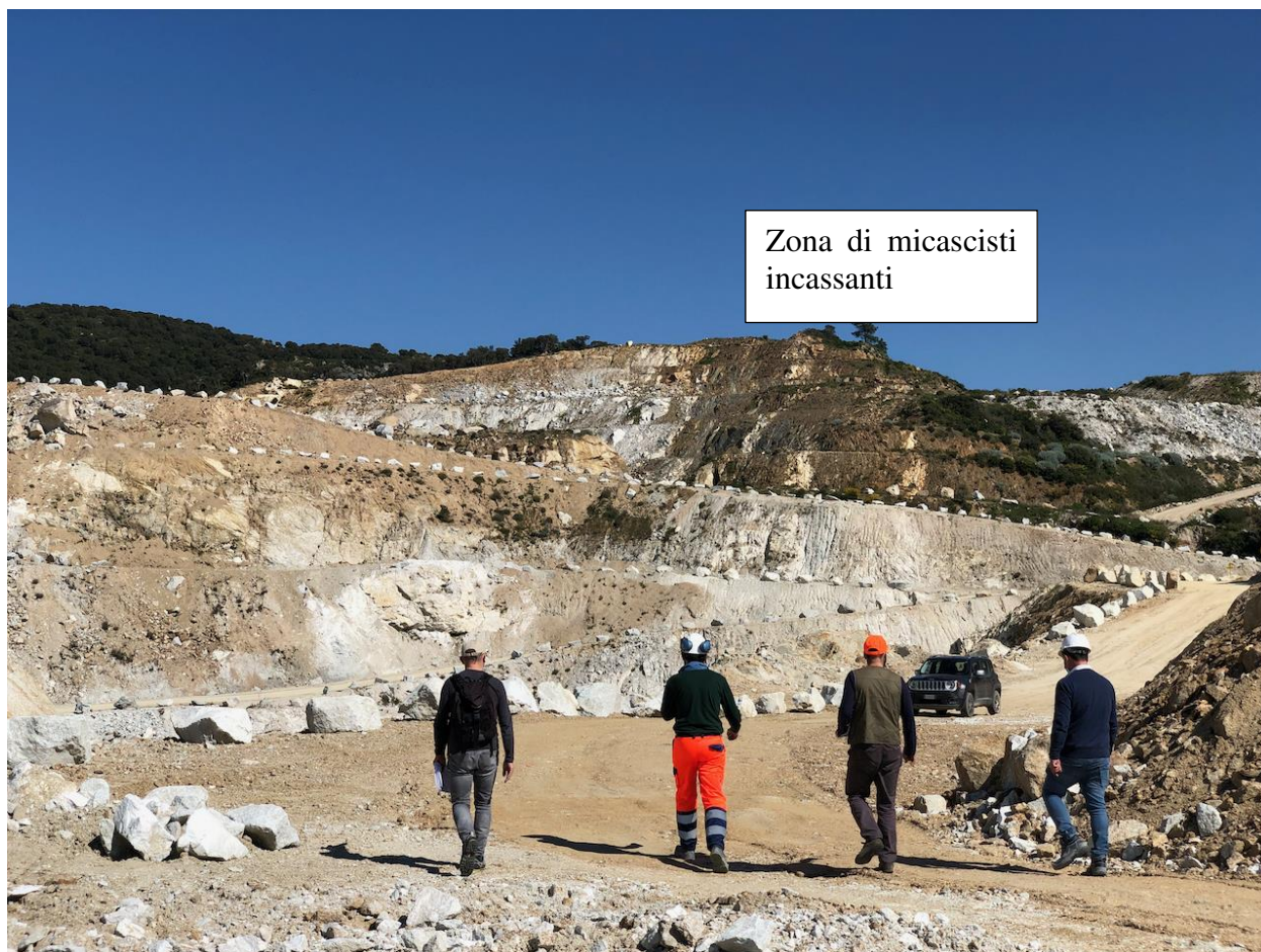
Foto 1: la parte alta della miniera dove sono evidenti le intercalazioni tettonizzate di micascisti incassanti delle plutoniti tardo erciniche
